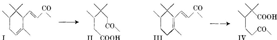
Wir haben synthetisches  $\alpha$ - und  $\beta$ -Iron ozonisiert und die Ozonide mit Wasserstoffperoxyd zersetzt<sup>3)</sup>. Nach Entfernen der mit Wasserdampf flüchtigen Anteile wurden die Rückstände destilliert, die Ketosäuren als Semicarbazone abgetrennt und diese durch Umkristallisieren gereinigt. Aus  $\alpha$ -Iron (I) gewann man das rohe Semicarbazone von II mit 3,7%, aus  $\beta$ -Iron (III) dasjenige von IV mit 24% Ausbeute.
